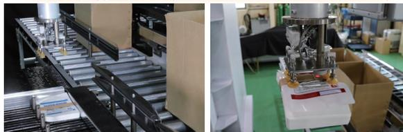
集積・帯掛け後の製品をロボットアームで箱詰め。
